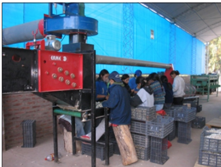
Figura 1 - Desgranadora mecánica y cinta de selección de dientes
